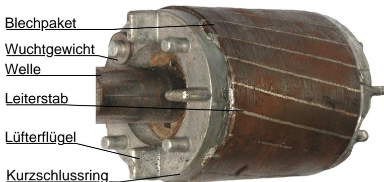
Abbildung 4.18: Käfigläufer einer kleineren Asynchronmaschine.
