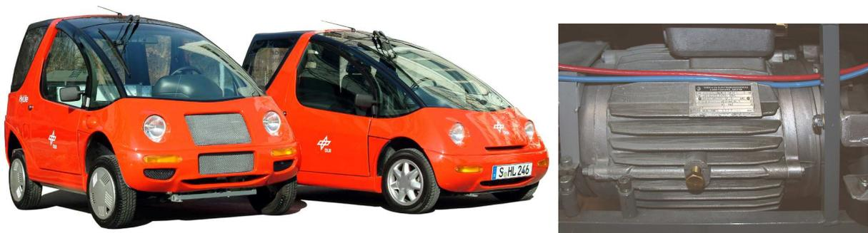
Abbildung 4.22: Beispiel für ein kleines Elektrofahrzeug, angetrieben durch eine Asynchronmaschine mit Käfigläufer. Daten der elektrischen Maschine: Nennleistung 12 kW (dauerhaft), Nenndrehzahl  $5920 \frac{1}{\text{min}}$  bei 200 Hz, Nennspannung 100 V und Nennstrom 86 A in Dreieck-Schaltung.
