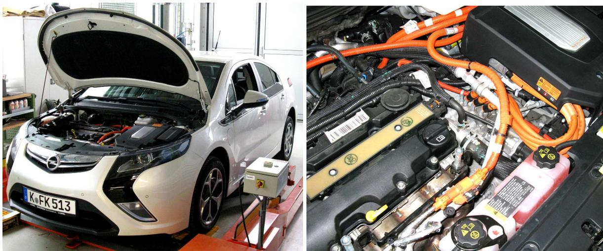
Abbildung 4.23: Opel Ampera, Beispiel für ein Hybridfahrzeug. Der Blick in den Motorraum zeigt links die Verbrennungskraftmaschine, in der Mitte die beiden elektrischen Maschinen in einem gemeinsamen Gehäuse und hinten rechts den Umrichter.
